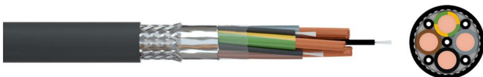
**Verwendung:** Halogenfreie und flammwidrige Leitung für das EMV-gerechte Anschließen von Frequenzumrichtern. Für die Verwendung bei mittleren mechanischen Beanspruchungen bei fester Verlegung und gelegentlicher Bewegung in Innenräumen, im Freien sowie direkt in Erde.
